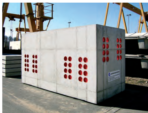
Szyb kablowy z kielichami rur
